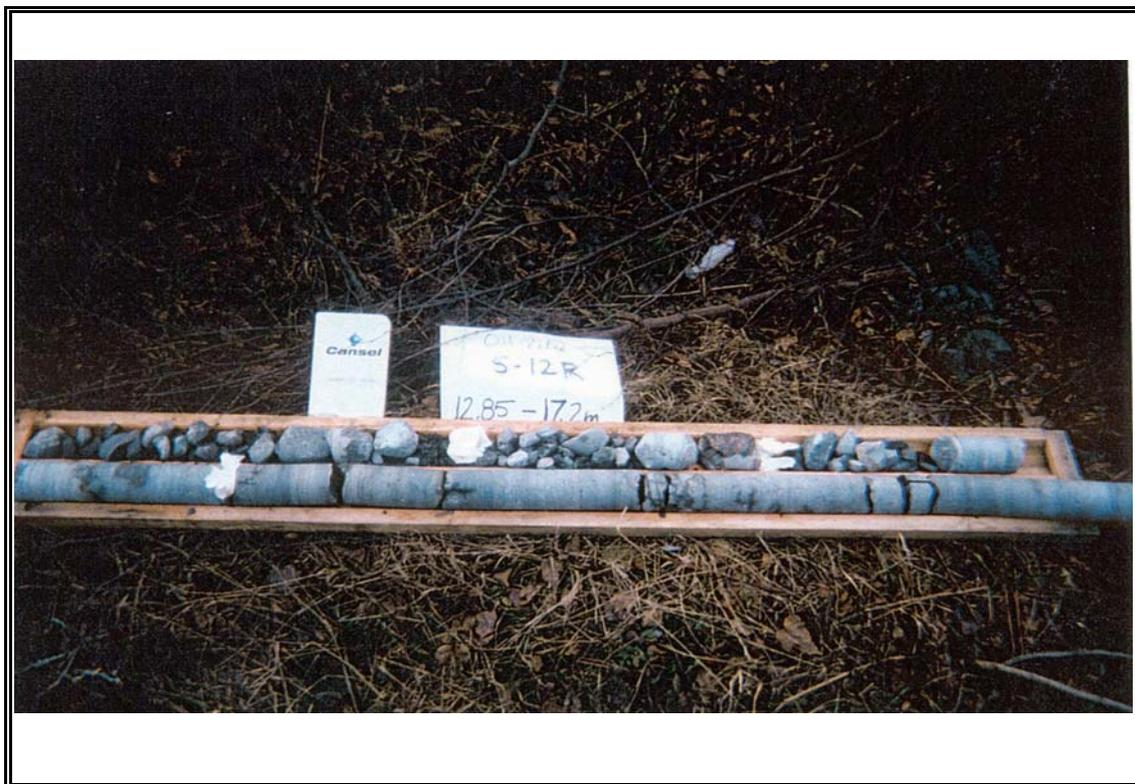
PHOTO 7 : Roc carotté au site de forage S-12, profondeur de 12,85 m à 17,20 m.
