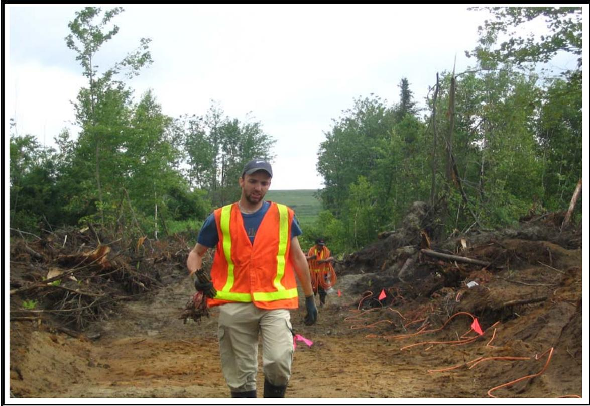
PHOTO 1 : Installation des instruments de mesure du levé géophysique par imagerie de résistivité électrique.
