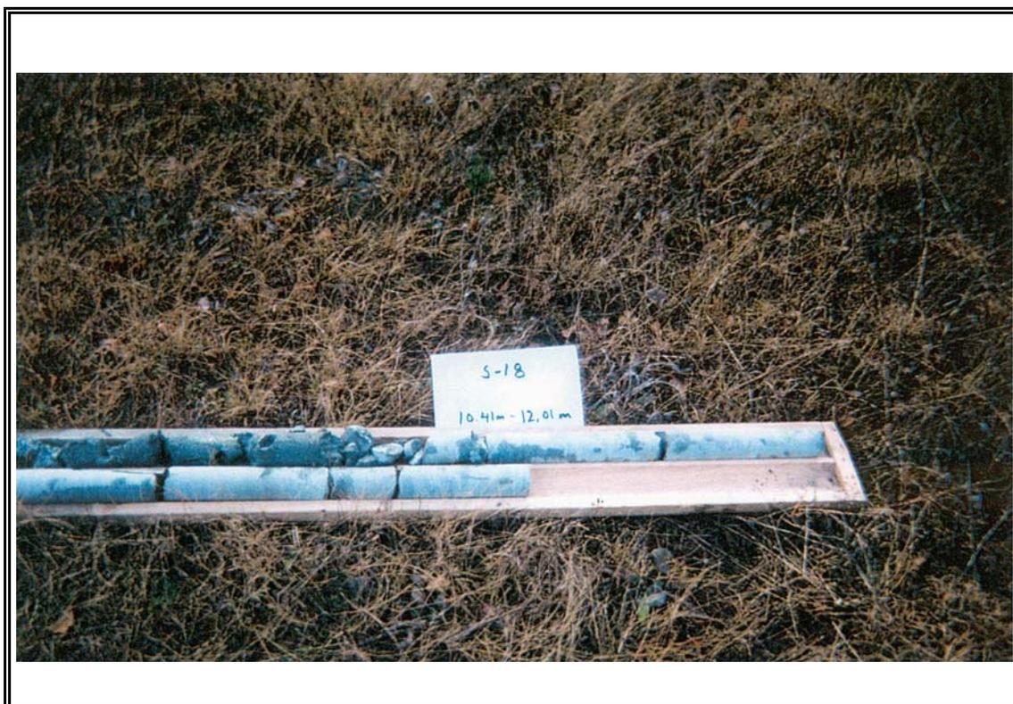
PHOTO 8 : Roc carotté site de forage S-18, profondeur de 10,41 m à 12,01 m.
